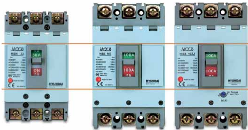
30, 50, 60 и 100AF Нерегулируемые термомагнитные I_n от 3 до 100A I_{cu} = 5 / 10 кА при 415 В 2, 3, 4 полюса Гидромагнитный блок расщепления
